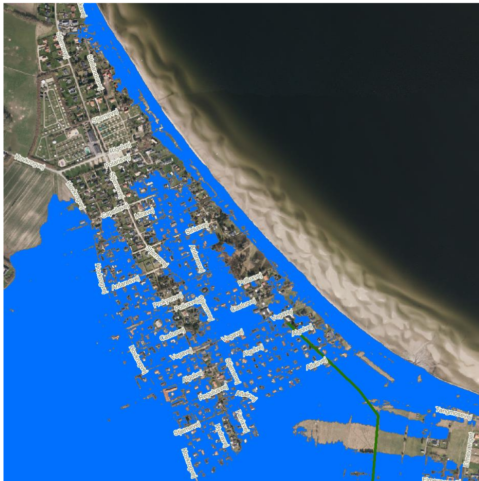
Figur 3.3. Påvirkede områder i Vejlbysted i 2050 ved en 20 års hændelse, som medfører en havvandstand på 1,8 m DVR90. Den grønne streg viser placering af nuværende dige
